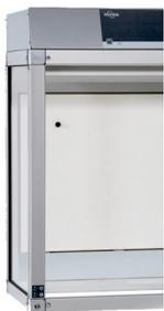
Le poste de travail pour produits dangereux respecte la norme EN 14175-3 et les valeurs limites d'exposition aux produits chimiques sur le lieu de travail. Une alarme sonore et visuelle se déclenche en cas d'anomalie au niveau du débit d'entrée et de sortie d'air.
