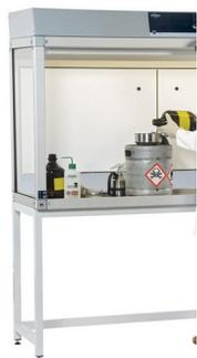
Le poste de travail à flux laminaires est monté sur un châssis avec plan de travail en inox brossé pour une manipulation de produits chimiques en position debout. Un rideau d'air se forme sur la face avant pour stopper les vapeurs nocives et les évacue vers le système d'extraction d'air du site.
