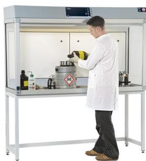
Le poste de travail à flux laminaires est équipé d'une mise à la terre montée sur profil d'aluminium, d'un éclairage interne et d'un déflecteur opaque rabattable.
