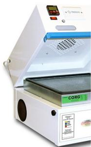
Le caisson à recirculation d'air Labopur®, est équipé d'un ventilateur électrique qui permet l'évacuation des vapeurs nocives et toxiques se trouvant dans votre armoire de sécurité. Le filtre à charbon actif traite ces vapeurs et les rejette dans l'air sans danger. Ce système de filtration est adaptable à tous les types d'armoires de sécurité.
